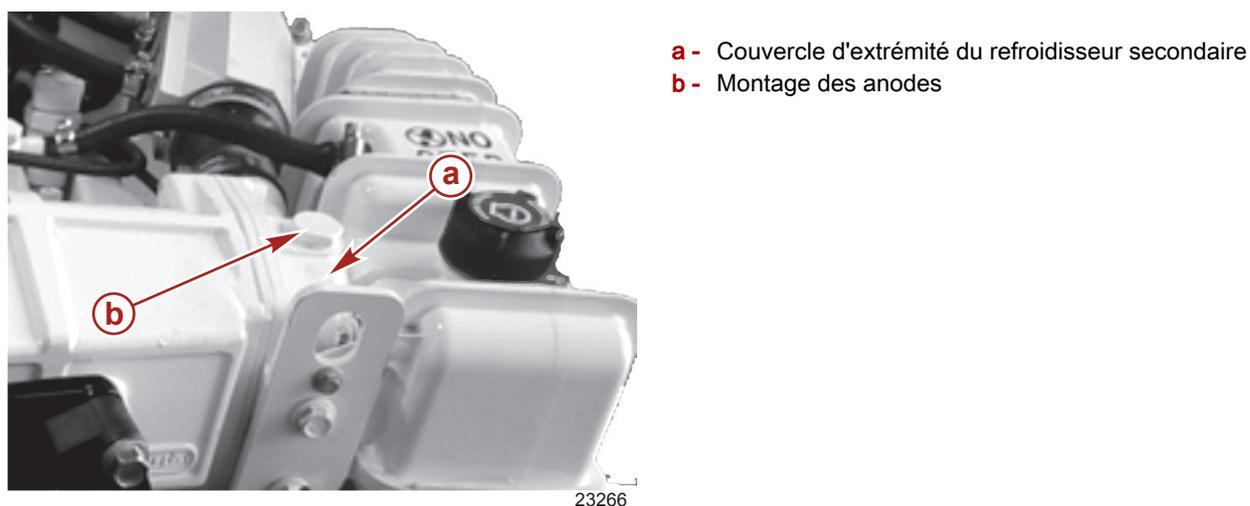
3. Sur les modèles 4.2, installer l'anode et la rondelle dans l'extrémité arrière du refroidisseur de liquide. Serrer fermement.
