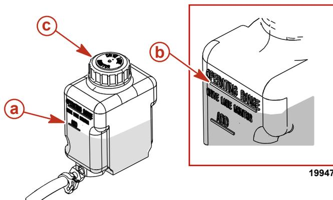
**Contrôleur de graissage d'embase**
