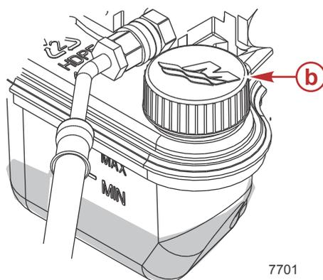
Le réservoir de la pompe de relevage hydraulique indique que le niveau d'huile est sous le repère « MIN »
