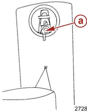
**Cavité de plaque anodique de transmission en Z**
