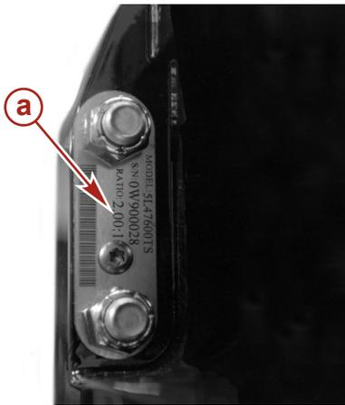
**a** - Plaque de masse reliant la transmission en Z au carter de transmission
