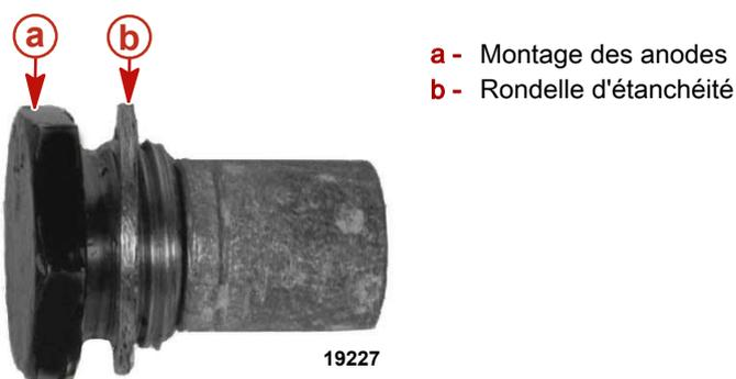
2. Installer l'anode et la rondelle dans le couvercle d'extrémité du refroidisseur secondaire. Serrer fermement.
